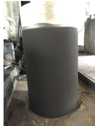
電解装置のドラムに電着した銀化合物
